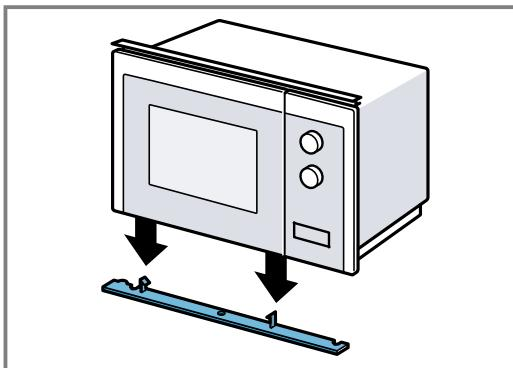
3. Aperte o parafuso central no fundo do micro-ondas.
