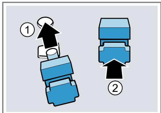
3. Introducir los soportes traseros con el gancho en el orificio superior ① y luego en el orificio inferior presionando ②.
