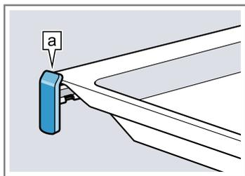
**Nota:** Totalmente extraídas, as calhas extensíveis encaixam. Empurre as calhas extensíveis para o interior do aparelho exercendo alguma pressão.
