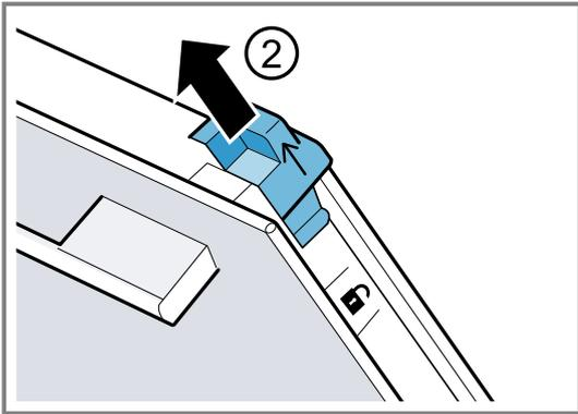
6. Retire o vidro interior obliquamente para cima e pouse-o sobre uma superfície plana.
