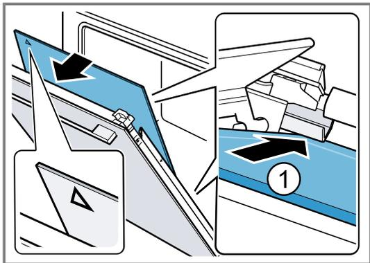
✓ O vidro intermédio posiciona-se automaticamente através do movimento rotativo do suporte distanciador.
