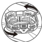
Gire el filtro cilíndrico hacia afuera con un movimiento en sentido antihorario.
