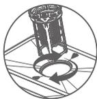
Después de la limpieza, puede volver a colocar el filtro. El filtro cilíndrico debe montarse con un movimiento en el sentido de las agujas del reloj hasta que las marcas triangulares del filtro, la red filtrante y el acero inoxidable se alineen simultáneamente.
