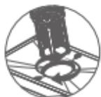
Après le nettoyage, vous pouvez remettre le filtre en place. Le filtre cylindrique doit être assemblé avec un mouvement dans le sens des aiguilles d'une montre jusqu'à ce que les marques triangulaires sur le filtre, le filet du filtre et l'acier inoxydable soient alignés simultanément.
