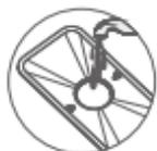
Utilisez de l'eau courante pour rincer l'ensemble du filtre. N'utilisez pas de laine d'acier ou de brosse en fer, car cela provoquerait la rouille du filtre.
