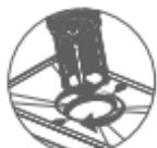
Dopo la pulizia, puoi rimontare il filtro. Il filtro cilindrico deve essere assemblato ruotando in senso orario fino a quando i segni triangolari sul filtro, sulla rete del filtro e sull'acciaio inox non sono allineati contemporaneamente.
