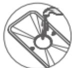
Utilizzare acqua corrente per risciacquare l'intero filtro. Non utilizzare lana d'acciaio o spazzole di ferro, poiché ciò potrebbe causare la ruggine del filtro.
