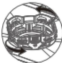
Ruotare il filtro cilindrico in senso antiorario per rimuoverlo.
